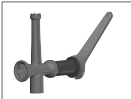
C. Loosen Lower Cap Dévissez le bouchon inférieur
