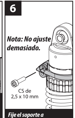
Fije el soporte a la estructura del amortiguador con un tornillo de cabeza avellanada de 2,5 x 10 mm incluido.
