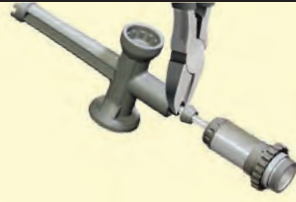
B. Serrez/desserrez le couvercle inférieur
