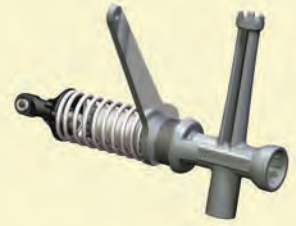
A. Serrez/desserrez le couvercle supérieur
